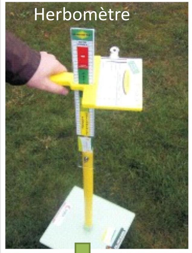
Mesure de la hauteur d'herbe, avec un petit tassement qui dépend de la densité de l'herbe -> permet de quantifier les « réserves » d'herbe -> planification du pâturage tournant
